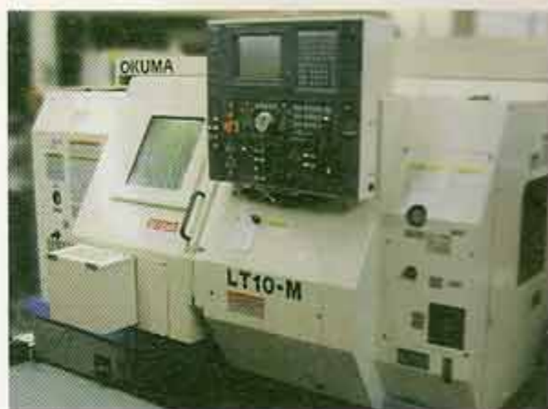
Centro di tornitura per particolari da diametro 8 a 100 mm
