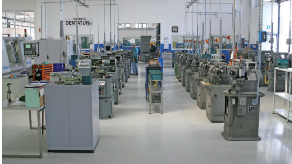
Nel reparto di dentatura di Anfabo operano dentatrici a creatore e a Cnc, per ingranaggi conici e per viti senza fine.
